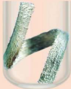
Bọt khí xuất hiện khi Mg tác dụng với H 2 O
